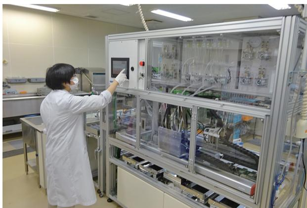
LABOTEC(株)製自動定量希釈DO測定装置
